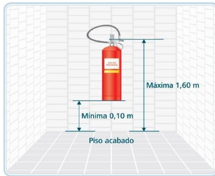
Figura 25 - Fixação extintor de incêndio
